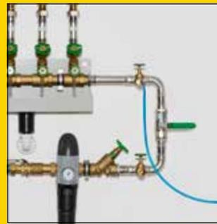
Comprobación de presión con aire comprimido (SL/SLW)
