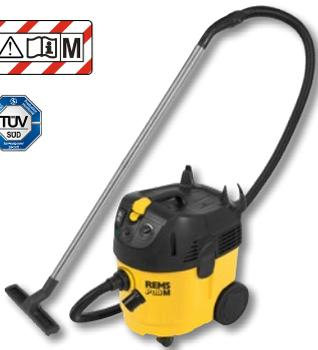
**REMS Pull M Set**, aspirador en seco y mojado, certificado como aspirador y eliminador de polvo para absorber polvo nocivo para la salud según EN 60335-2-69. Categoría de polvo M. Valor límite de explosión / valor límite en puesto de trabajo > 0,1 mg/m<sup>3</sup>, grado de paso ≤ 0,1 %.
